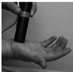
Figure 1. La photopléthysmographie est une technique non invasive permettant d'étudier grâce à une cellule photoélectrique le débit sanguin cutané ou musculaire par mesure de la réflexion sur la peau d'une lumière infrarouge.
